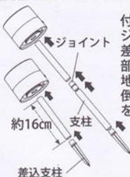
付属の支柱を1本（またはジョイントを使用して2本）差込支柱とつなぎ裏蓋中央部に差し込んでください。地面などに垂直に差し込み、倒れたりしないかよく確認をして設置ください。
