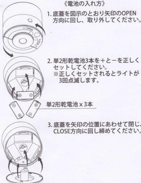
1. 底蓋を図示のとおり矢印のOPEN方向に回し、取り外してください。
