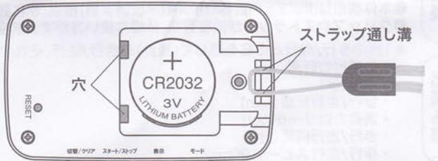
3. 新しい電池を、図の様に+(プラス)面を表にして入れます。(コイン型リチウム電池 CR2032×1個)
